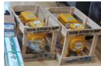
เครื่องสูบน้ำแบบหยอชิง ขนาด ๕ แรงม้า
